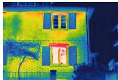
Abb. 9: Erhöhter Wärmeabfluss im Bereich des Fenstersturzes durch Thermographie sichtbar gemacht.
